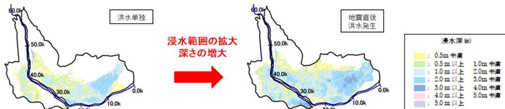
洪水単独災害と地震と洪水の複合災害の氾濫シミュレーション比較
