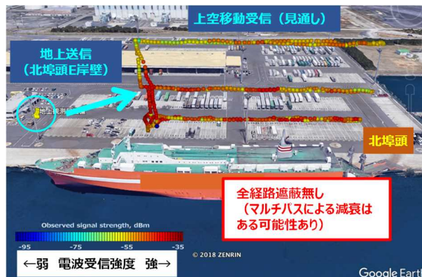
図-5.8 電波伝搬特性測定結果（遮蔽無し）
