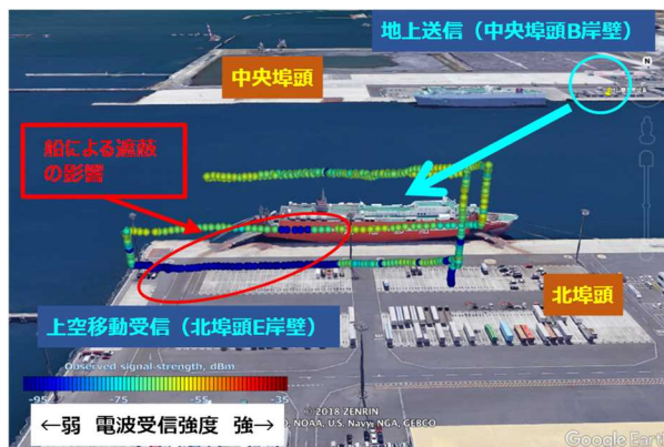
図-5.7 電波伝搬特性測定結果（船舶による遮蔽あり）
