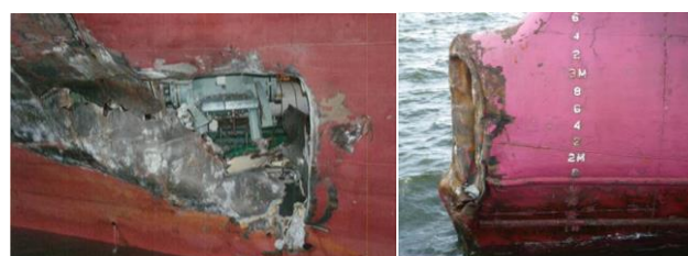
(a)船側部の破口 (b)バルバス・バウの圧壊
