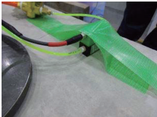
流量計（解像度 0.001ml/min）
