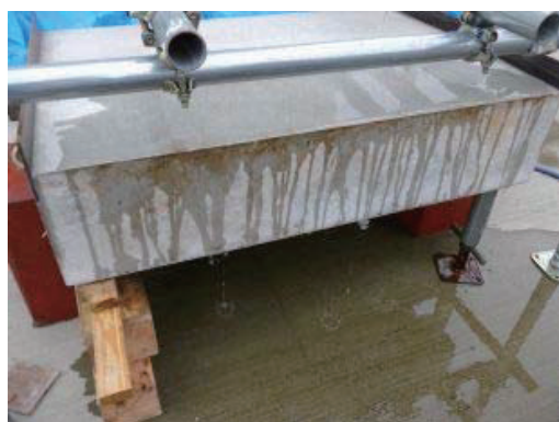
散水試験状況 (100mm/h)
