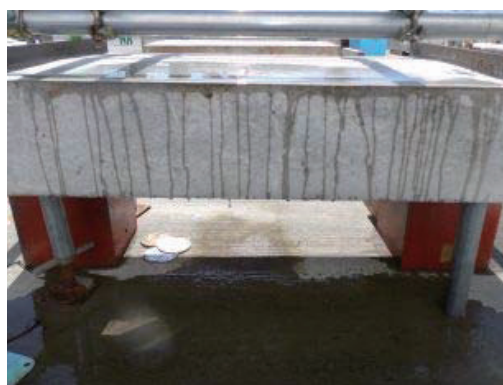
散水試験状況 (5mm/h)
