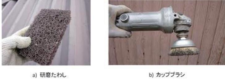
写真-1 塗替え時の使用ツールの例
