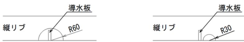
(a) 開口を導水板が貫通 (b) 導水板を縦リブに溶接
