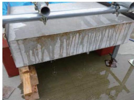
(b) 散水試験状況（100mm/h）
