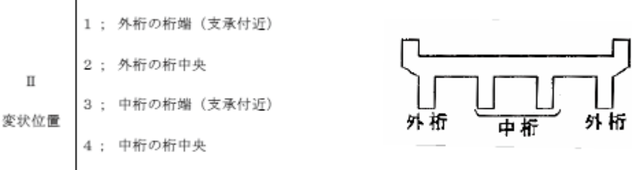
図-1.2.94(d) 供用年数と変状内容 (コンクリート橋主桁II (変状位置)) (平成28年調査)
