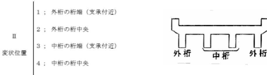
図-1.2.94(c) 供用年数と変状内容 (コンクリート橋主桁II (変状位置)) (平成18年調査)
