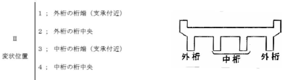
図-1.2.94(e) 供用年数と変状内容 (コンクリート橋主桁II (変状位置)) (全調査)
