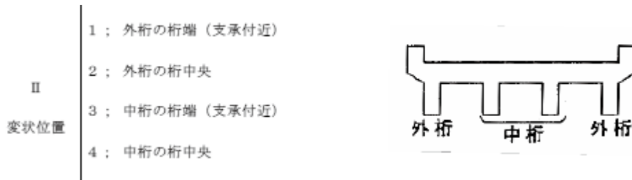
図-1.2.94(b) 供用年数と変状内容 (コンクリート橋主桁II (変状位置)) (平成8年調査)
