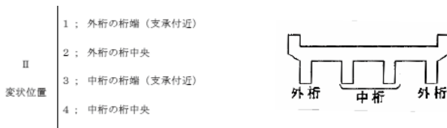
図-1.2.94(a) 供用年数と変状内容（コンクリート橋主桁Ⅱ（変状位置））（昭和61年調査）
