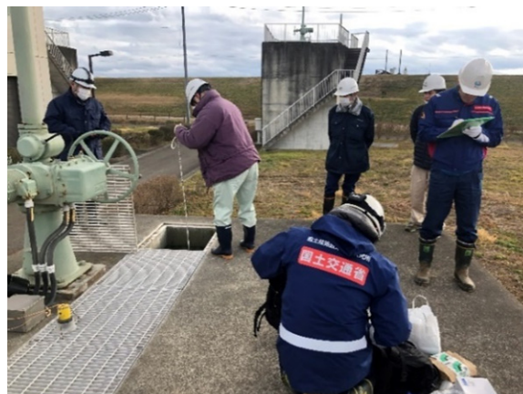
写真-4.13 放流水採水状況
