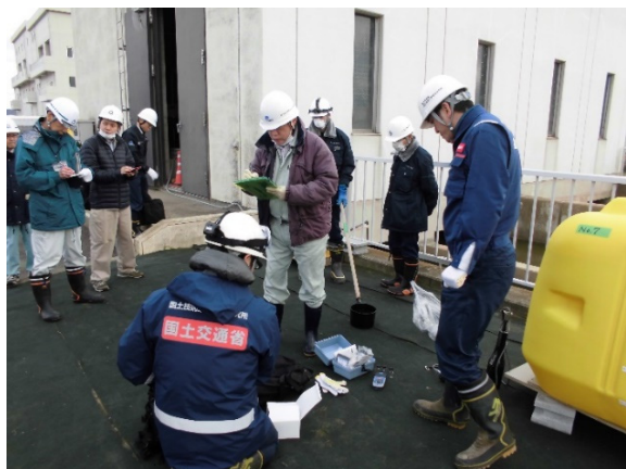
写真-4.12 塩素混和池残留塩素測定状況
