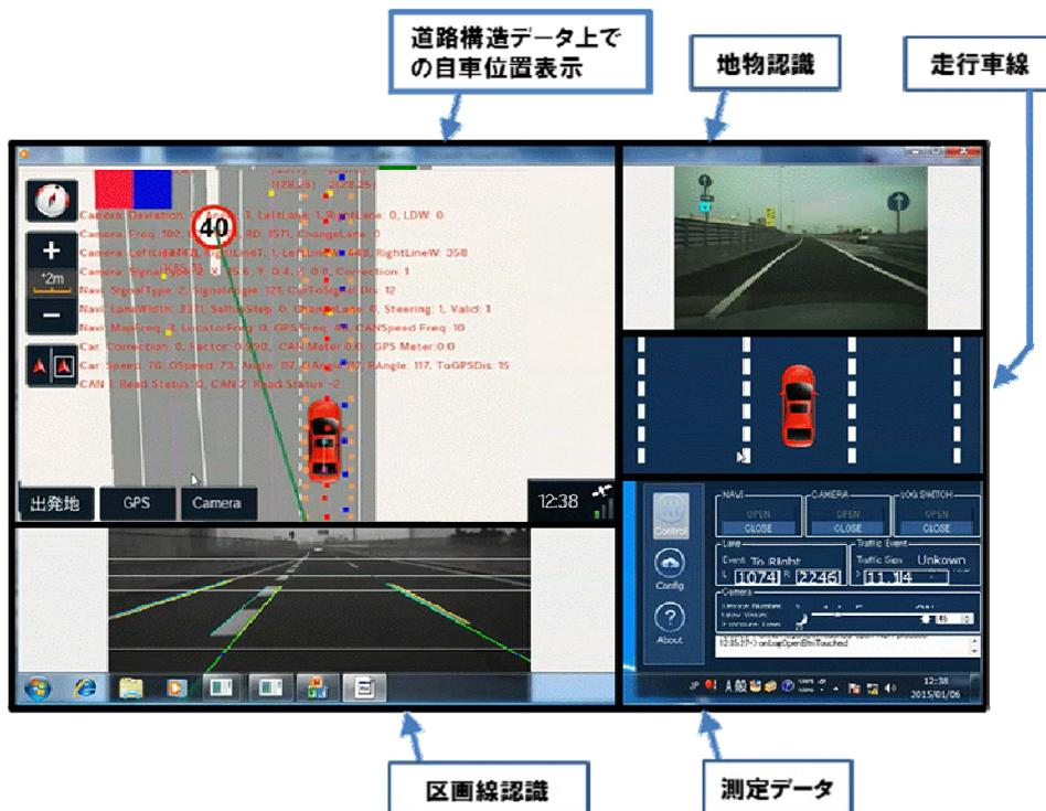
(再掲)試作データによる実道実験画面（前ページの図を拡大）
