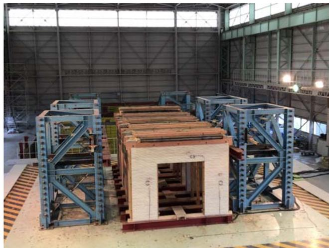
構造性能評価手法の精度検証のための木造軸組躯体振動実験の例
