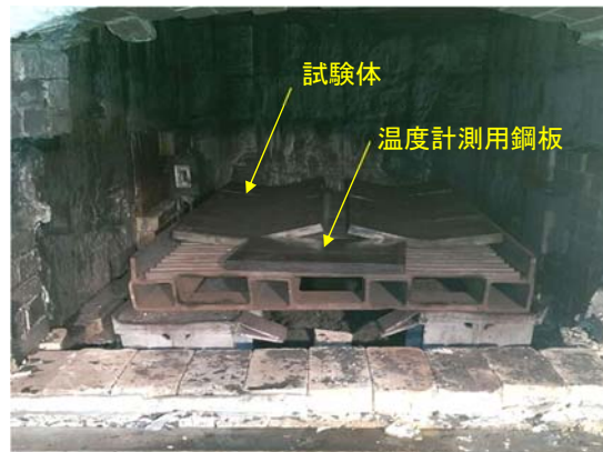
写真-3.2.4 時効促進処理の施工状況
