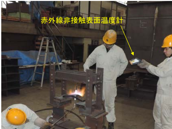
a) SS400、SM490YB 試験体の加熱
