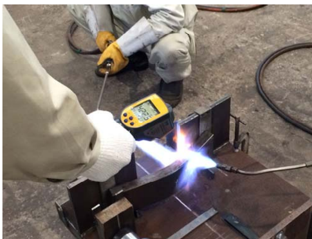
参-写真-3.1.1 非接触型表面温度計の使用状況
