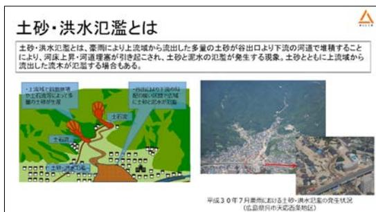
ここで土砂・洪水氾濫につきまして簡単に説明しておきます。土砂・洪水氾濫というのは、豪雨によりまして上流域から流出した多量の土砂が、谷出口付近から下流の河道で堆積することにより、河床上昇とか、河道閉塞が引き起こされ、土砂とか泥水の氾濫が発生するという現象で、こちらはポンチ絵で紹介していますが、上流から流木等も流れてきて氾濫することもあります。
