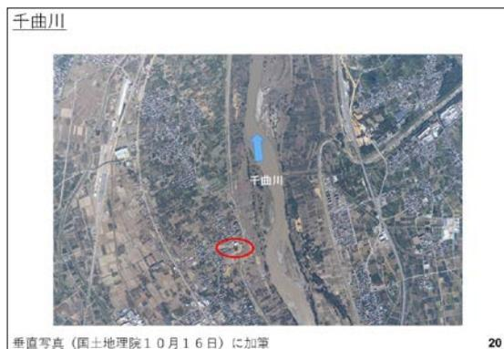
70メートル程度の決壊が生じまして、ここ（写真左側）が川ですけど、こちら側に非常に深い落っ掘りと呼ばれる洗掘されたような箇所が見られ、堤防が越流によって破堤したということが推察されております。ここは堤防の前後1.5キロの間で越水しているということです。
