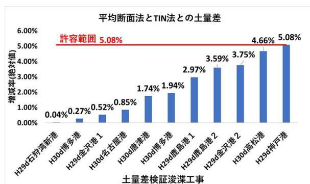
図-4.4 平均断面法と TIN 法との土量差の許容範囲設定
