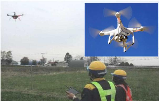
図-2.3 UAV を活用した 3次元測量<sup>3)</sup>
