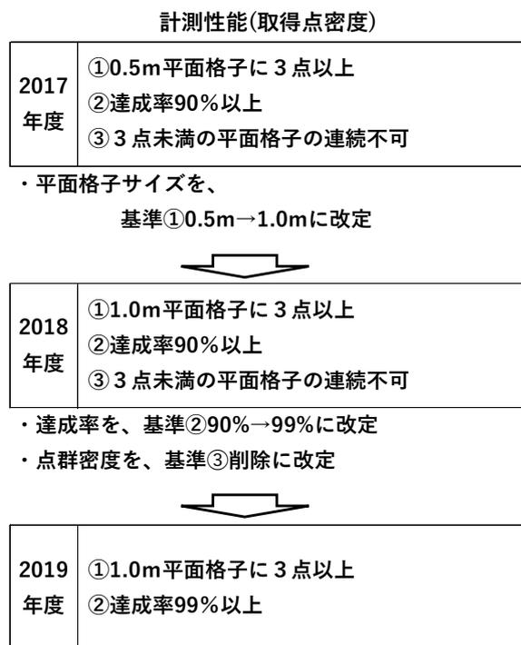
図-3.4 計測性能（取得点密度）の改定<sup>20~21)</sup>
