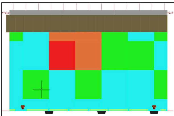
図-B.4 エプロン劣化度判定表示（上からの視点）
