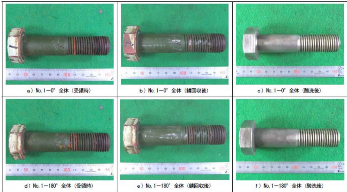
写真 5. 3. 3 暴露ボルト No. 1 の外観
