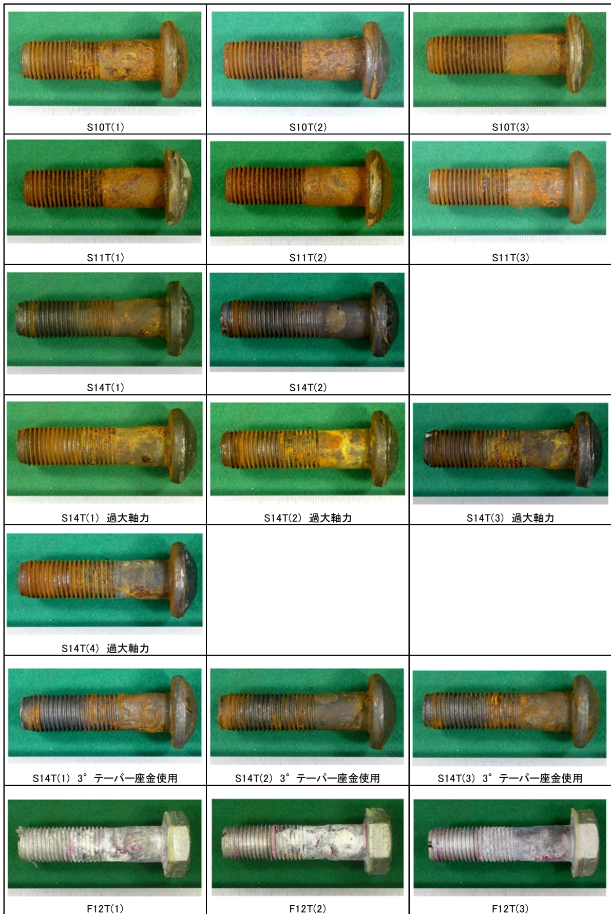
写真 4.2.4 試験後のボルト外観
