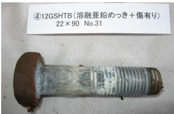
(d) ④F12T (溶融亜鉛めっき処理、傷有り)
