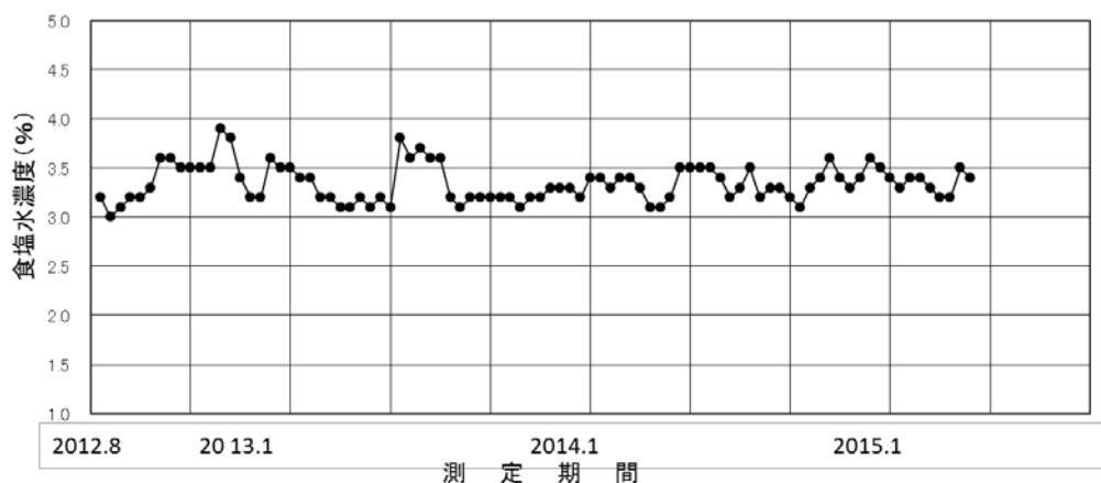
図 4.1.6 観覧車腐食促進試験（食塩水濃度推移）
