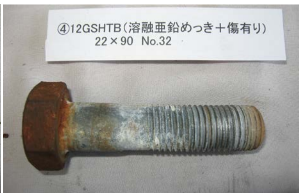
(d) ④F12T (溶融亜鉛めっき処理、傷有り)
