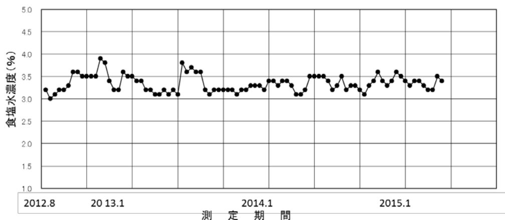
図 4.1.6 観覧車腐食促進試験（食塩水濃度推移）
