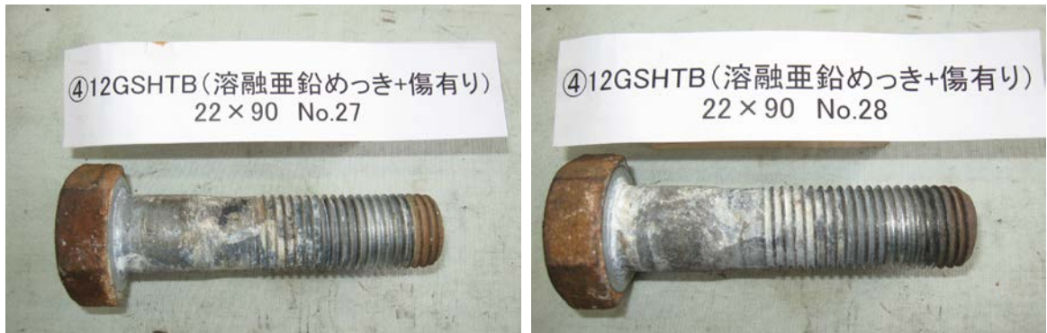
(d) ④F12T (溶融亜鉛めっき処理、傷有り)
