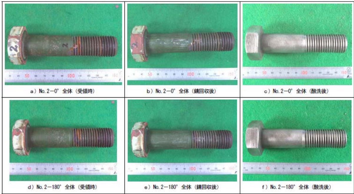
写真 5. 3. 5 暴露ボルト No. 2 の外観
