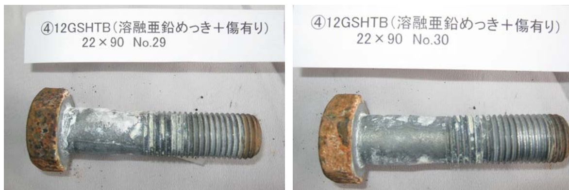
(d) ④F12T (溶融亜鉛めっき処理、傷有り)
