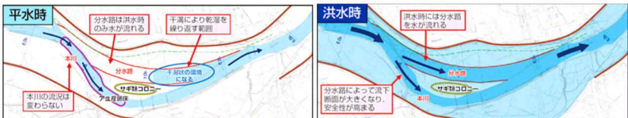
図 1.1.7 久慈川における分水路整備での河道掘削の計画図 11)
