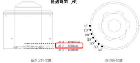
【無動力攪拌式消化槽 処理水による底部流速実測データ】
