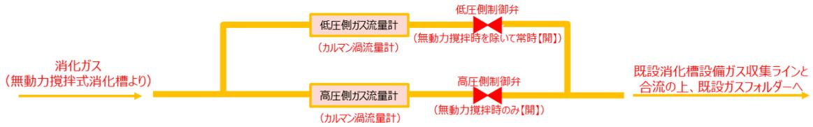
実証設備消化ガス流量計周り概略図
