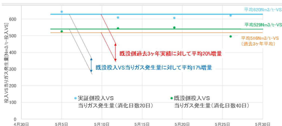
図資 1.13 可溶化によるバイオガス発生増量効果
