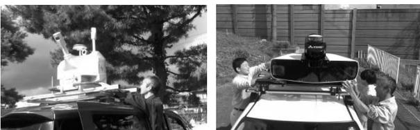
図-1 車両搭載センシング機器の取り付け作業
