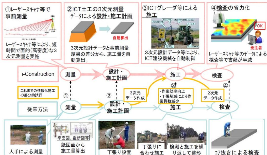
図-2.2 ICT 舗装工の概要<sup>4)</sup>
