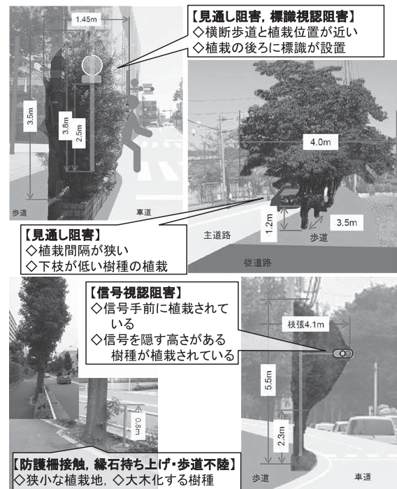
図-3 街路樹による交通障害の発生事例
