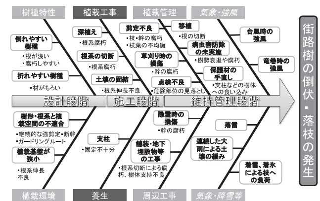
図-5 倒伏・落枝の主な発生要因の推測
