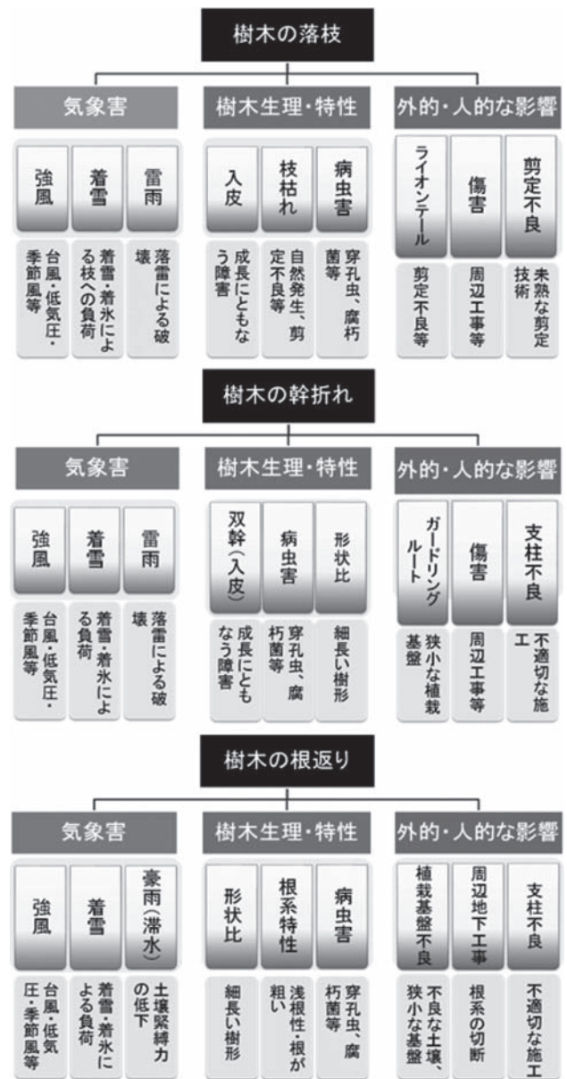
図-6. 倒伏・落枝の発生要因（被害形態別）
