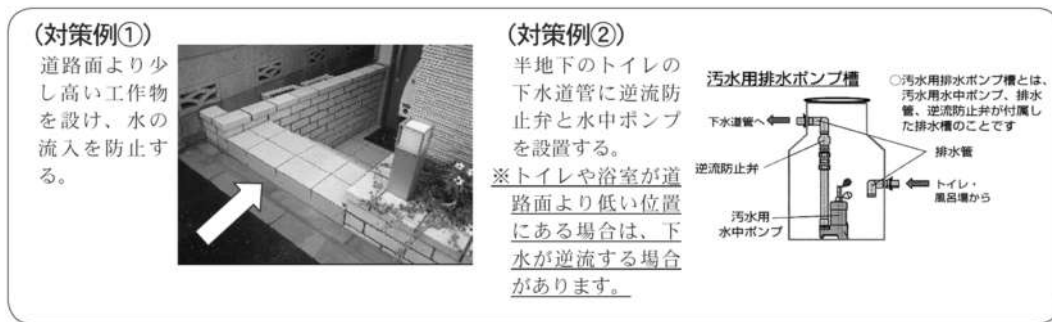
図 5.2.56 「世田谷区建築物浸水予防対策要綱」説明資料による対策の例
