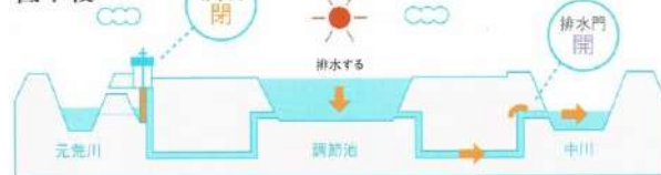
図 5.2.22 大相模調節池の貯留・排水システム概念図 (出典:独立行政法人都市再生機構資料)
