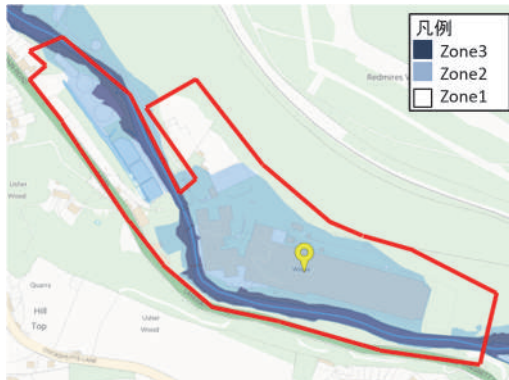
図 5.2.95 シェフィールド市事例 3 の洪水ゾーン区分 (出典:GOV.UK「Likelihood of flooding in this area」を加工)
