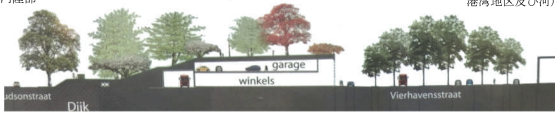
図 5.2.111 ルーフ・パーク断面図（右方向が港湾地区及び河川）
