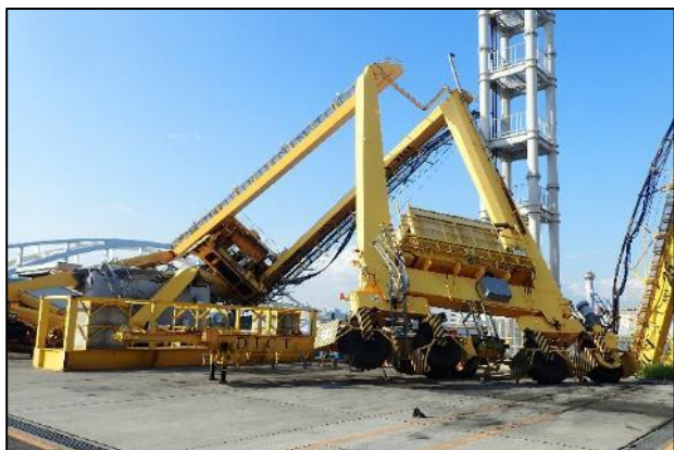
写真 5-2 トランスファークレーン倒壊（大阪港）
