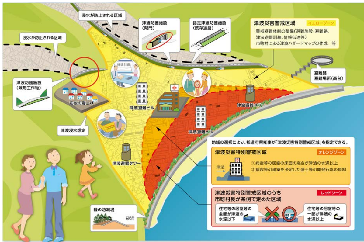
図-1.1.1 津波防災地域づくりにおける指定津波防護施設及び津波防護施設のイメージ (出典：国土交通省 津波防災地域づくりに関する法律パンフレット 7) )
