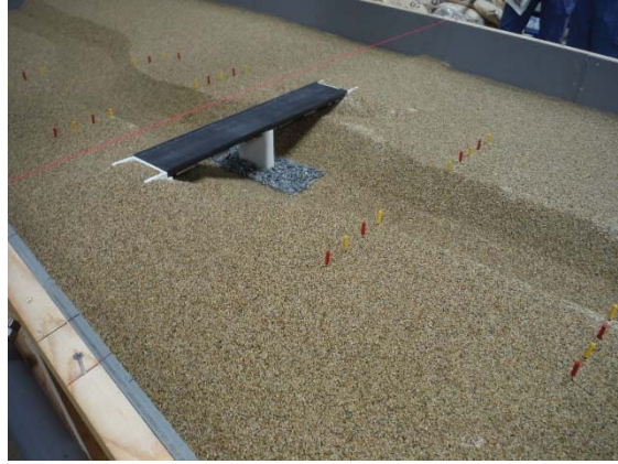
ii) 設置した橋梁と背面盛土
