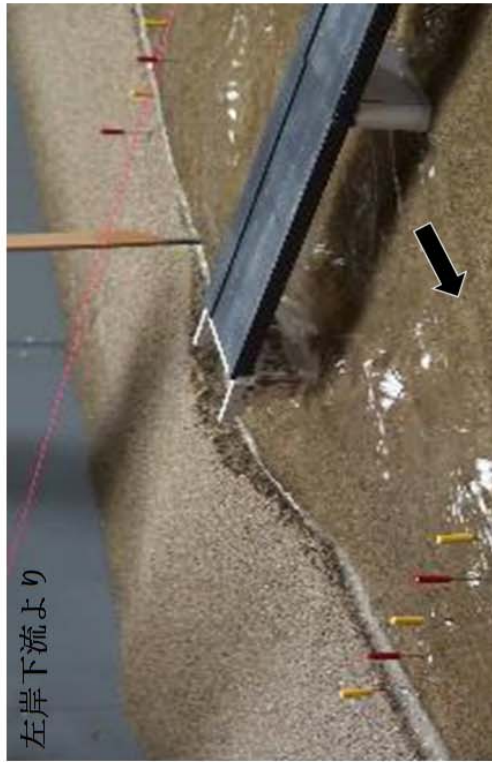
図-4.2.3.3(g) 水路平面形状及び右岸側橋台周辺の変化（通水開始後12.5分）
