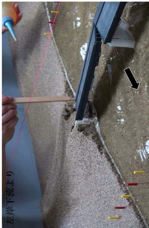
図-4.2.2.3(g) 水路平面形状及び右岸側橋台周辺の変化（通水開始後11分）
