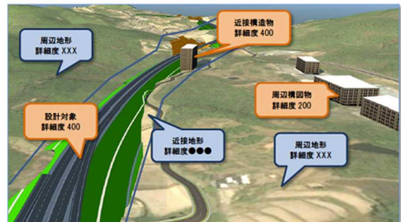
図-2.6 モデル内での詳細度混在のケース 14)
