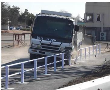
実車による防護柵衝突実験
