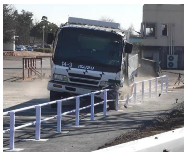
実車による防護柵衝突実験
