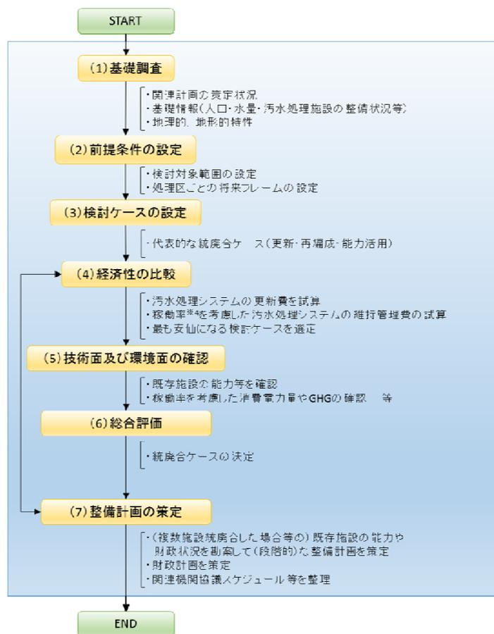
図-9 効率的な汚水処理システムの最適化検討フロー
