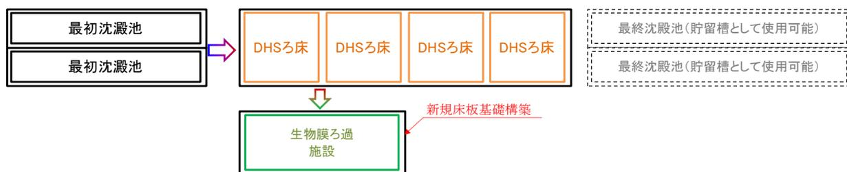
(b) 既存反応タンク内に DHSろ床を地上に生物膜ろ過施設を設置する場合
