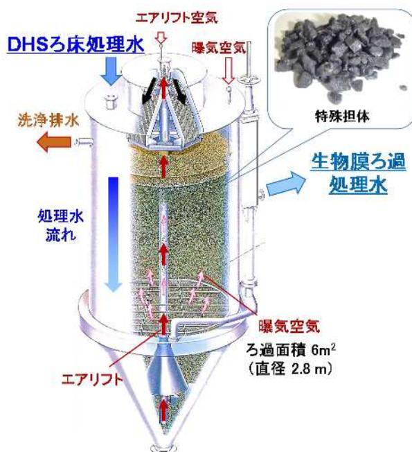
図 2-14 生物膜ろ過槽全体図
