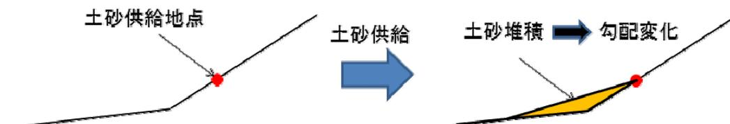
図 2.4 土砂堆積により土砂供給地点の勾配が変化するイメージ
