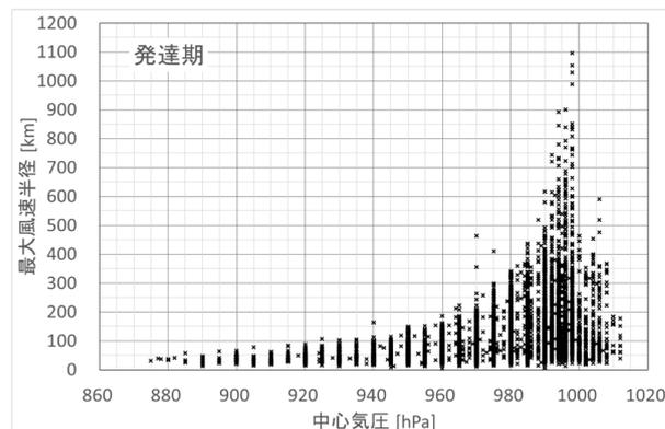
図-1.1 中心気圧と最大風速半径（発達期）
