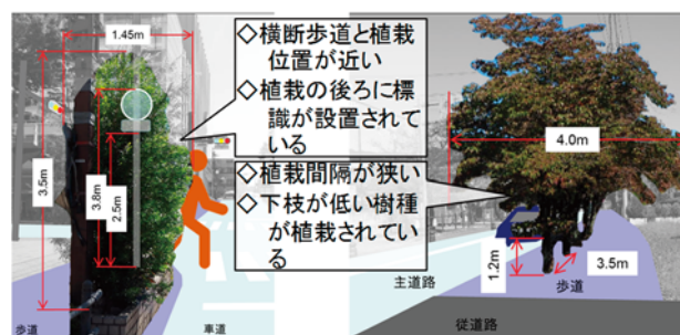
図-1 樹木による見通し阻害の発生例
