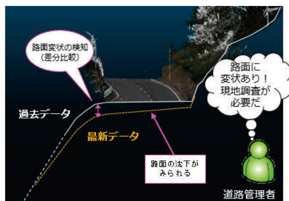
図-1 路面変状の検知イメージ
