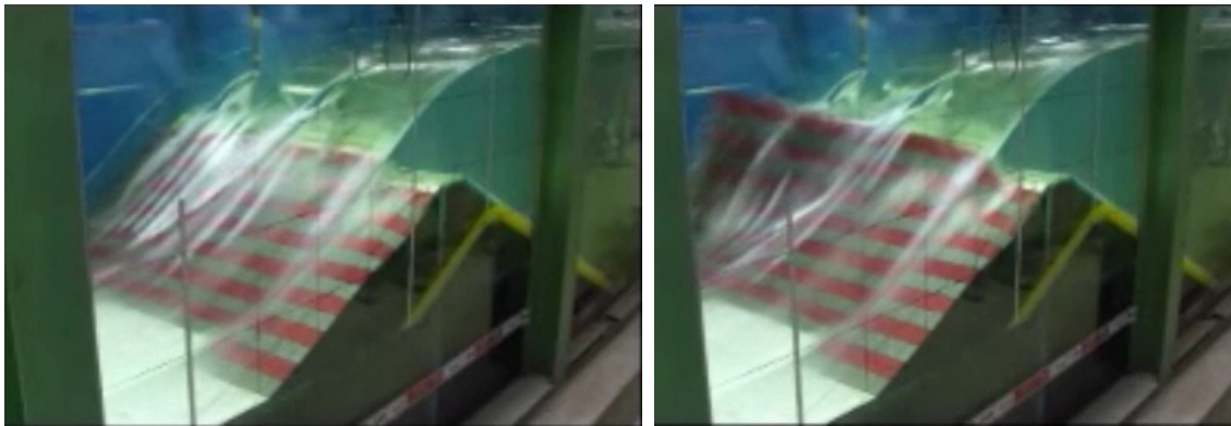
写真-2.2.4.2 裏法被覆工のめくれ (左：めくれる前、右：めくれた瞬間)
