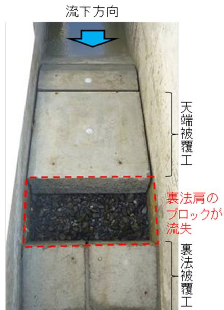
**写真-2.2.5.1** 水理模型実験で見られた裏法肩のコンクリートの流失
