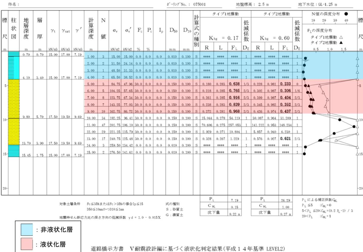
道路橋示方書 V耐震設計編に基づく液状化判定結果(平成14年基準 LEVEL2)
