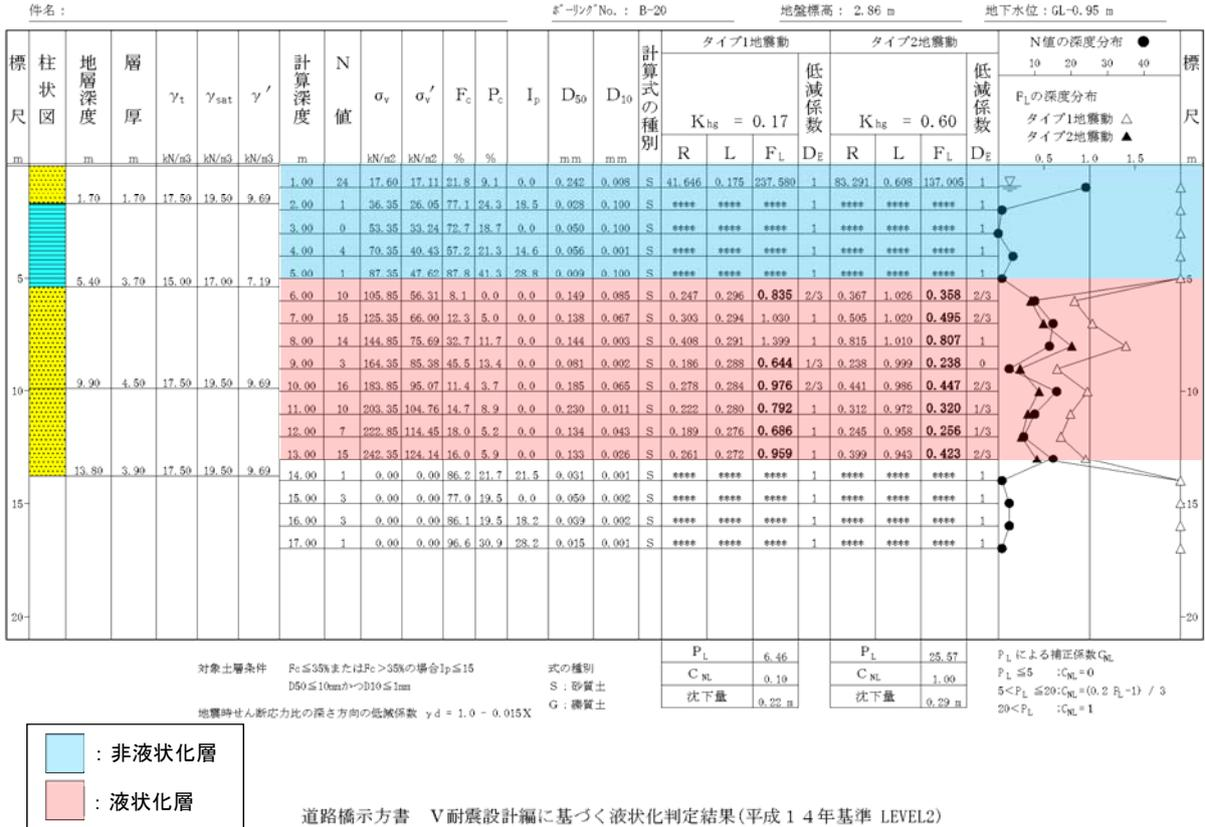
道路橋示方書 V耐震設計編に基づく液状化判定結果(平成14年基準 LEVEL2)
