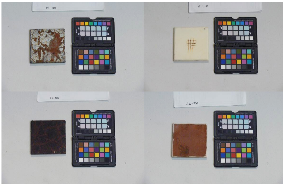
図 5.2.3 鋼部材の腐食供試体
