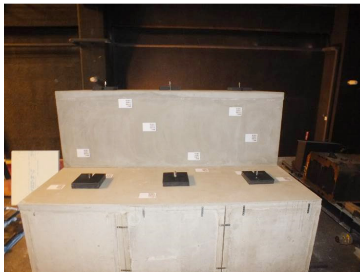
模擬損傷設置状況（下側部材）
