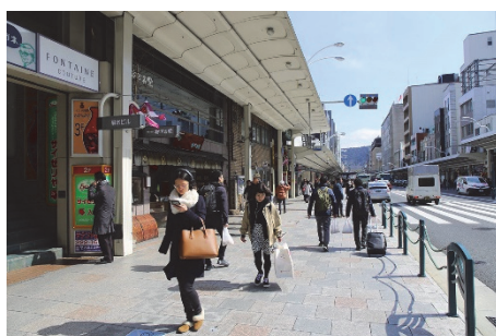
幅員再構成による目抜き通りの歩道拡幅 61：四条通（京都市）
