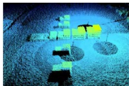
図-4.49 水中 3D スキャナー計測例 69)
