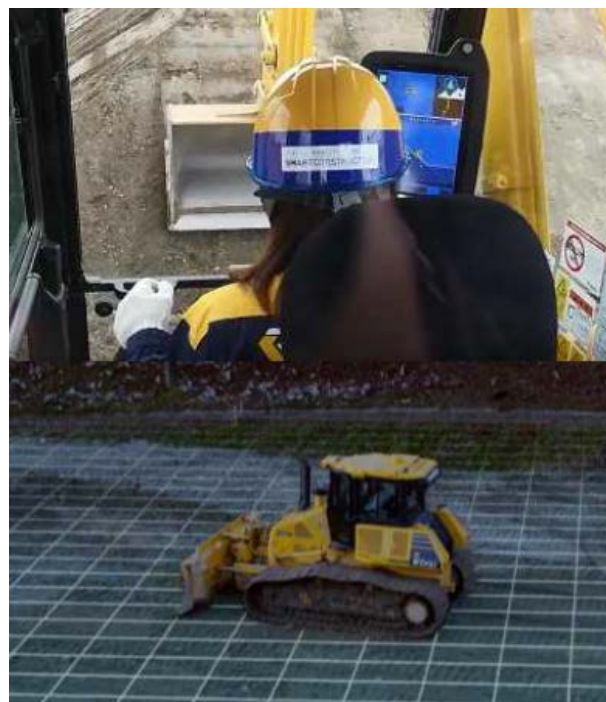
図-2.8 ICT 建設機械による施工 15)
