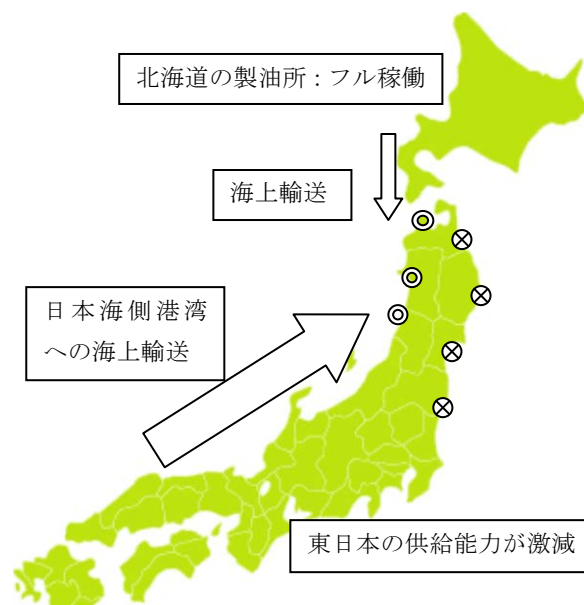
図4.1 東日本大震災後の石油の代替輸送例 10)
