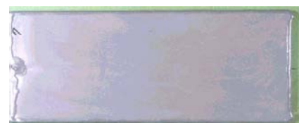
写真 4-2 耐酸性試験後の供試体の状況
