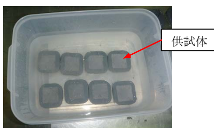
写真 2-3 硫酸水溶液浸漬の様子
