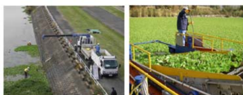
図-10 機械や清掃船による回収
