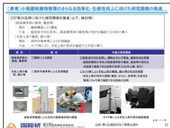
ここで、標識柱等の基部においては、土中やコンクリート埋め込み部で鋼材が腐食している場合があります。また、支柱部での亀裂点検には高所作業車等が必要となります。これらの点検において、例えば超音波探傷器による調査等の新しい技術について、その有効性を確認しつつ、使っていきたいと思っています。
