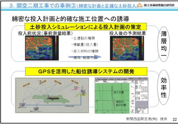
また、土砂を均一に投入するために、投入前の状況、それから投入したらどのように深さが変わるかを事前にシミュレーションし、またGPSを使いまして、船の位置を正確に把握しながら、投入位置をコントロールしてきたということがございます。
