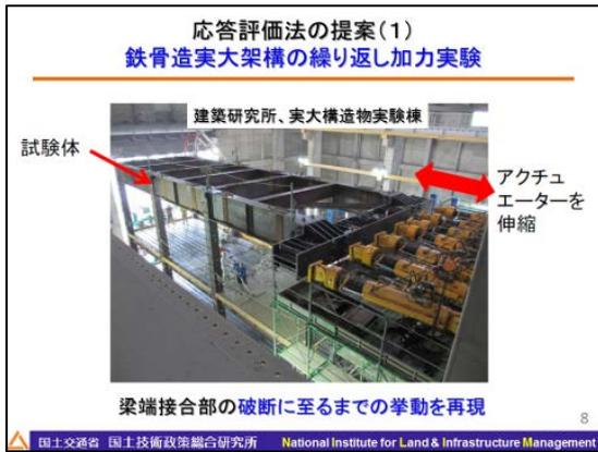
次に、建築物の応答側の検討です。これは、鉄骨造の実大架構の繰り返し加力実験で、試験体は実際の超高層建築物から、途中の3層部分を取り出してきたようなものですが、これにアクチュエーターで何度も繰り返し加力を行い、梁端接合部の溶接部の破断が、どういうときに起きるかを調べるために、それが起きるまでの挙動を再現した実験です。
