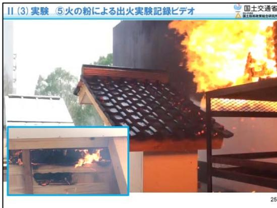
手前の木材が燃えているところから、火の粉が屋根の上に飛んでいって降り積もっている。これは昔の瓦なのですが、隙間に結構入っています。屋内からみると、下地に燃え移って、こういう形で屋根裏に燃え広がるという現象が見られました。
